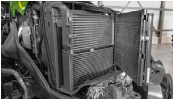
Mindre ansträngning: Det kompakta kylarpaketet är mycket åtkomligt och kan rengöras snabbt och enkelt tack vare det väl tilltagna utrymmet mellan kylarna och radiatorns platta nederdel.
