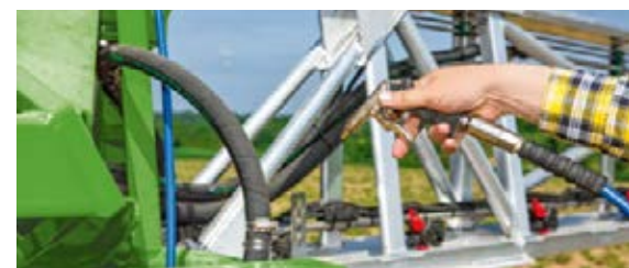
□ Tryckluftspistolen (tillval) är placerad baktill på bommen vilket underlättar rengöring.
