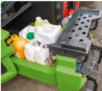
Ett tråg skyddar mot läckage från behållarna.
