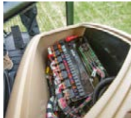
■ Lättåtkomligt centralt elsystem med uttag för FENDIAS diagnosystem.
