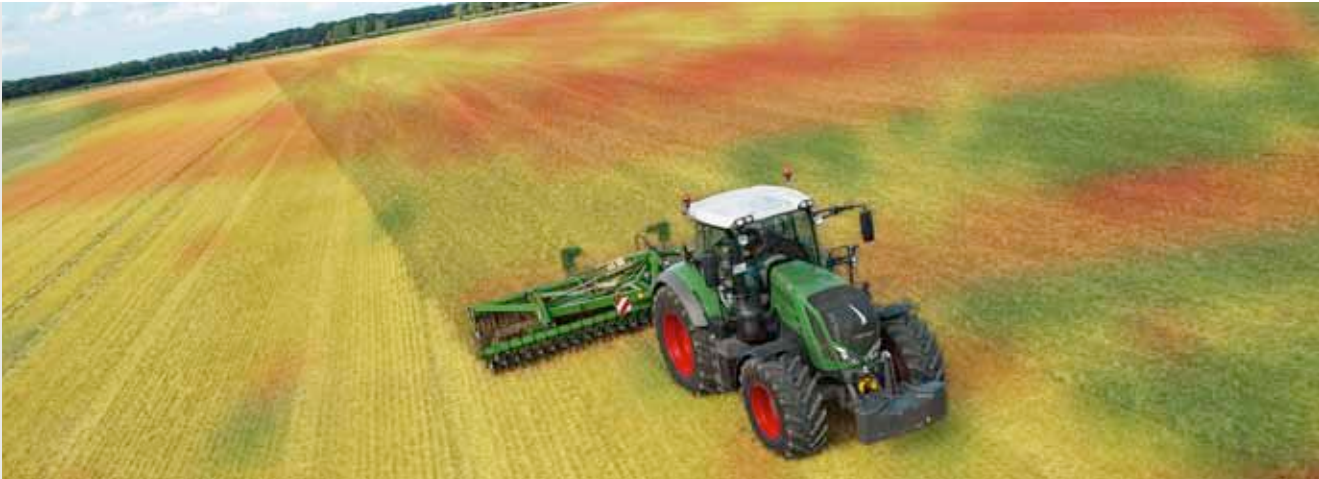
Korrekt positionsdata för ditt växtodlingsprogram med VarioDoc Pro. Maskindata som t.ex. motorens varvtal, bränsleförbrukning eller kraftuttagsvarvtalet kan registreras för varje position. Beroende på vilken version du har kan du visualisera det arbete som utförts grafiskt på din dator, t.ex. med hjälp av kartor som visar den relativa bränsleförbrukningen eller erforderlig dragkraft. Detta är en avsevärd fördel jämfört med icke-integrerade, eftermonterade system.
