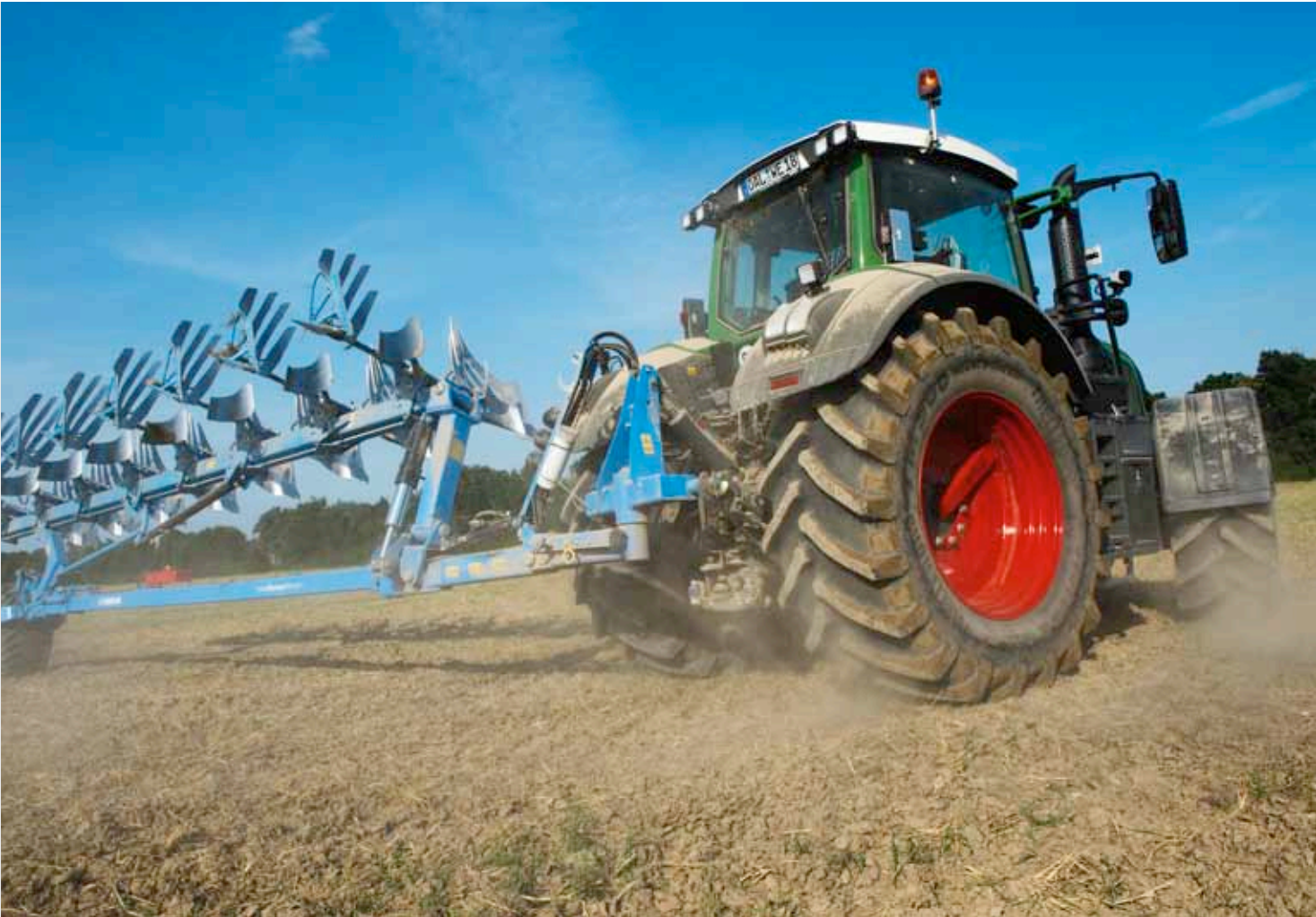
Med Variotronic TI vändtegsautomatik kan föraren skapa och spara sekvenser för vändningsmanövrer när traktorn körs eller står still. Inställningar för motor- och transmissionsstyrning, hydraulventilerna, frontlyften och den bakre trepunktslyften, det främre och bakre kraftuttaget och det automatiska styrsystemet samt deras individuella funktioner görs via vändtegsautomatiksystemet och kan enkelt öppnas.
