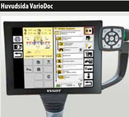
Korrekt positionsdata för ditt växtodlingsprogram med VarioDoc Pro. Maskindata som t.ex. motorens varvtal, bränsleförbrukning eller kraftuttagsvarvtalet kan registreras för varje position. Beroende på vilken version du har kan du visualisera det arbete som utförts grafiskt på din dator, t.ex. med hjälp av kartor som visar den relativa bränsleförbrukningen eller erforderlig dragkraft. Detta är en avsevärd fördel jämfört med icke-integrerade, eftermonterade system.
