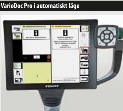
Korrekt positionsdata för ditt växtodlingsprogram med VarioDoc Pro. Maskindata som t.ex. motorens varvtal, bränsleförbrukning eller kraftuttagsvarvtalet kan registreras för varje position. Beroende på vilken version du har kan du visualisera det arbete som utförts grafiskt på din dator, t.ex. med hjälp av kartor som visar den relativa bränsleförbrukningen eller erforderlig dragkraft. Detta är en avsevärd fördel jämfört med icke-integrerade, eftermonterade system.
