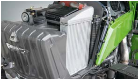
Kylsystemet har stora inloppsområden med optimal lufttillförsel. Fördel: låg förorening under extrema förhållanden. Transmissionsoljekylaren koler hydrauloljan med en värmeväxlare.
