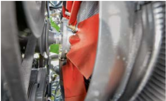
Bakre fläktar med justerbara fläktblad för särskilt dammiga förhållanden. Fördel: blåser rent kylgallret utan att du behöver gå ut ur hytten – för ökad prestanda och effektivitet.
