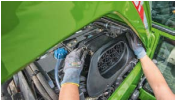
Luftfiltret med Zyklon-förrenare står för maximal prestanda hos luftflödet och filterlivslängden. Det är kompakt, lätt och mycket vältätat. Fördel: lågt underhåll.
