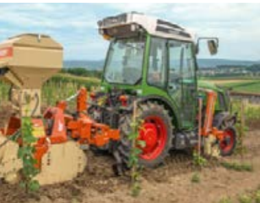
Montering mellan axlarna för effektiv användning av flexibla redskapskombinationer.
