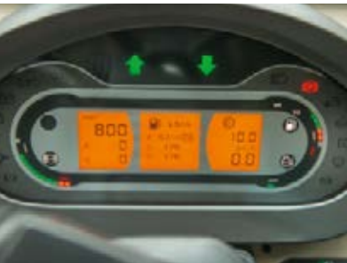
Alltid koll – den högpresterande multifunktionsdisplayen visar allt du behöver, till exempel aktuell och genomsnittlig bränsleförbrukning eller arbetad yta.
