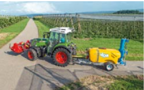
Effektiv kombination av processer. Med det främre kraftuttaget på 540E/750 kan du matcha varvtalet med hastigheten, medan det bakmonterade redskapet och traktorn arbetar med sänkt motorvarvtal.
