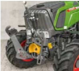
Frontlyften har lyftkraften 2 540 daN på den helintegrerade P-varianten. Sedan finns det vibrationsdämpning så att du kan arbeta i säkerhet och komfort.
