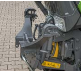
De nedre armarna på den helt integrerade främre hydrauliken kan vikas in kompakt på bara några steg. Den kompakta designen gör 200 Vario särskilt manövrerbar även med ett frontfäste.
