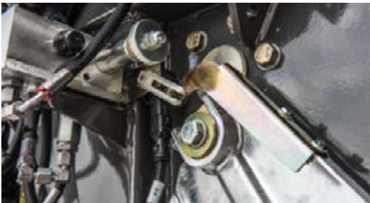
Med dragstångens positionsstyrning upprätthålls och kontrolleras pickupens inställda öppningsvinkel hela tiden. Därmed kan grödan flöda jämnt och obehindrat, och all gröda samlas upp, t.o.m. i kuperad terräng.
