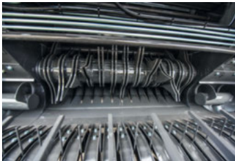
Rotor XtraCut13 (avstånd mellan fingerpar: 90 mm) - Utan skärenhet (standard) - Med skärenhet: Upp till 13 knivar
