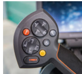
■ OptiControl-flerfunktionsspak som är optimerad för växtskydd.
