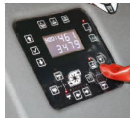
■ OptiFlow-styrenhet: Placerad längs induktionstratten för enkel kontroll av samtliga omrörare och funktioner under påfyllningsprocessen.
