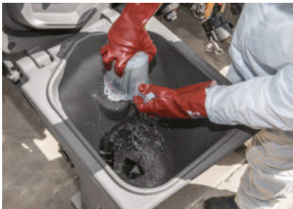
Använd den roterande spoldysan i spolventilen för att enkelt och säkert spola rent mätbägare och behållare.
