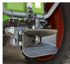
□ Automatisk dragkoppling med broms och elanslutningar.
