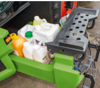
Ett tråg skyddar mot läckage från behållarna.
