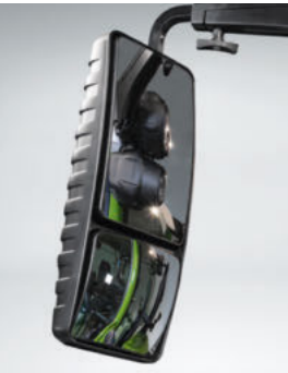
Elektriskt justerbara backspeglar Backspeglarna med separata vidvinkelspeglar säkerställer bästa möjliga överblick och maximal säkerhet. Ställ in dem enkelt via terminalen eller med hjälp av ett tryckvred.
