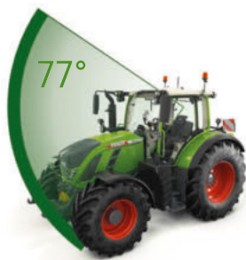
Den välvda vindrutan på VisioPlus-hyppen ger en betraktningvinkel på 77°.
