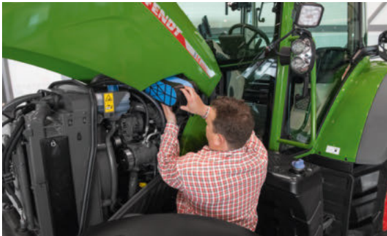
De högpresterande luftfiltren ger optimalt intag av luft och rengöring och är enkla att ersätta.
