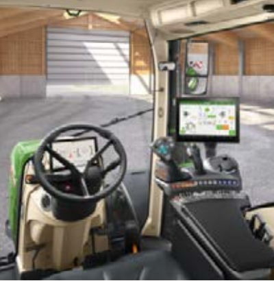
Profi+ Setting 2 - 3L-joystick - 1 linjär modul (vippbrytarpar) för styrning av hydraulventilerna - 12-tums terminal
