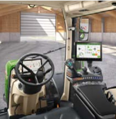
Profi+ Setting 1 - Fyrvägsspak - 1 linjär modul (vippbrytarpar) för styrning av hydraulventilerna - 12-tums terminal
