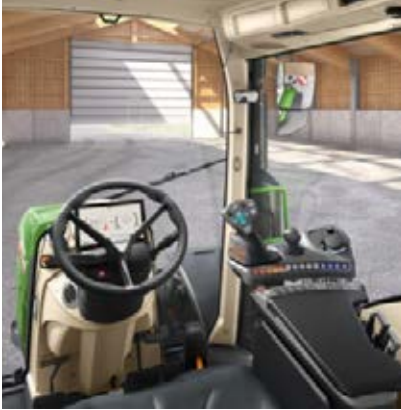
Power Setting 2 - Fyrvägsspak - Ingen linjär modul (vippbrytarpar)
