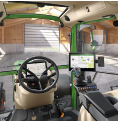
Profi+ Inställning 1 - Fyrvägsspak - 2 linjära moduler (spakar) för styrning av hydraulventilerna - 12-tums terminal
