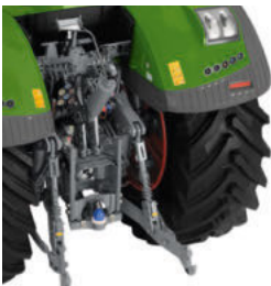
Bakre lyft med snabbkopplingskrok och sidostöd (EU)
