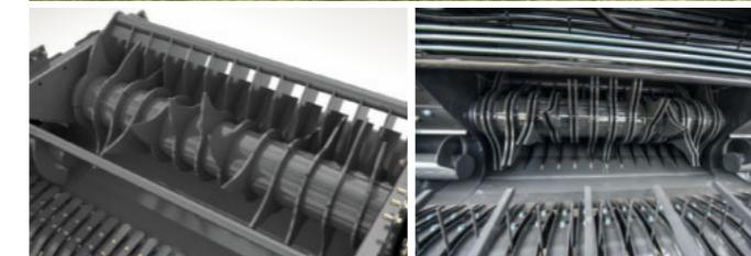
Подавальний ротор без різального апарату
