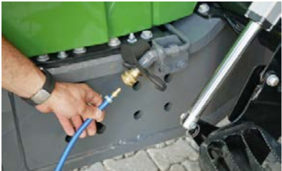
В передній частині трактора знаходиться роз'єм для компресора задля очищення радіатора.
