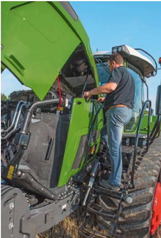
До відсіку двигуна можна дістатися буквально за мить, знявши бічні панелі.
