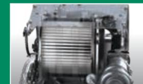
La soupape thermostatique du préfiltre à carburant permet au tracteur de bien démarrer, même sous de basses températures extérieures. Le radiateur et le filtre sont faciles d'accès pour l'entretien.
