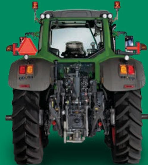
*La capacité (optionnelle) du relevage 3-points avant et/ou arrière à fournir une pression vers le bas prend toute son importance au moment d'utiliser certains types d'équipements de travail du sol ou de soulever le tracteur afin d'installer ou d'enlever les roues doubles.*
