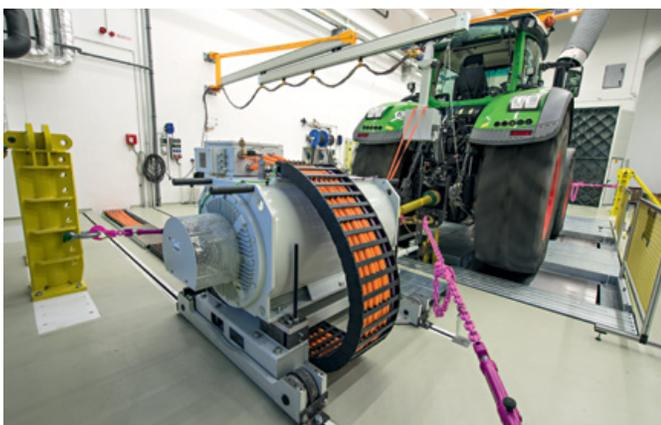
À l'arrière-plan : la buse d'alimentation à structure alvéolaire souffle de l'air dans la salle d'essai, créant un flux laminaire allant jusqu'à 12 1/2 miles par heure.
