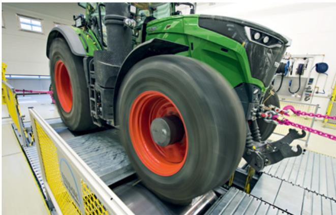
Photo du haut : Les chaînes roses de série peuvent résister à des forces allant jusqu'à 22 tonnes. Ci-dessus : la distance entre les essieux peut être réglée de 6 1/2 pi à 19 1/2 pi, ce qui garantit que tous les tracteurs peuvent être mis à l'essai, depuis la série 200 jusqu'à la série 1000.
